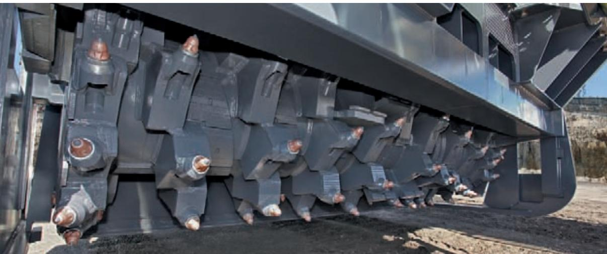
1 Фрезерный барабан Wirtgen 4200 SM
