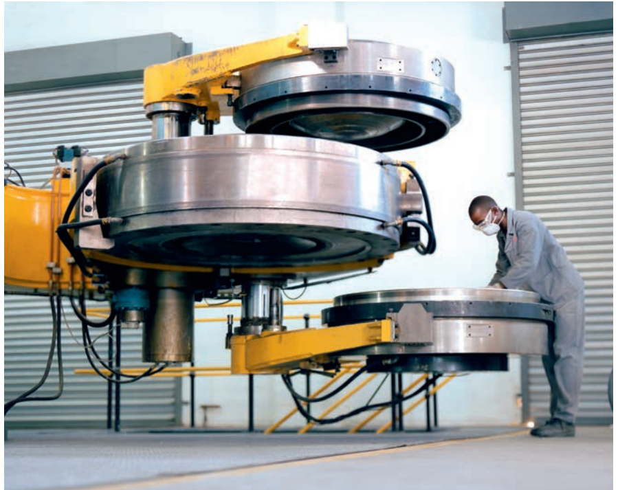
> Пресс для изготовления наконечников PCD в условиях высокого давления и высокой температуры
